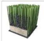
Sistema de césped artificial de última generación, fabricado mediante sistema TUFTING de una medida de 40x40 cm con 16 puntas, resultando 8.750 puntas/m² con filamentos del césped en verde color de 80 mm de altura y 13.000 OMS.
